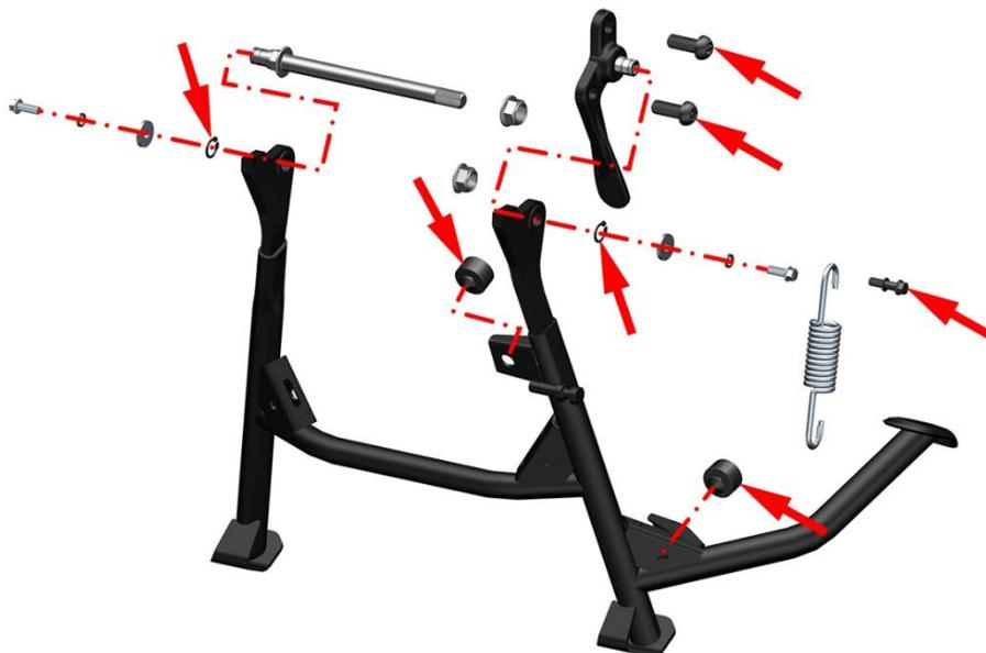
Inspeccione las piezas indicadas por las flechas en la imagen de arriba, y el método de desmontaje se detalla a continuación.
