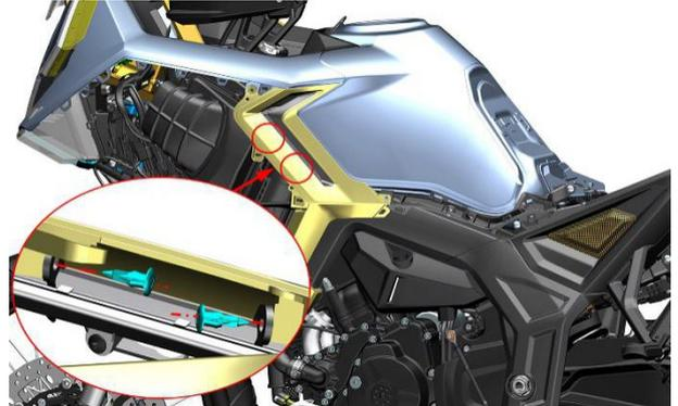
g. Tire suavemente de la parte inferior del sobre izquierdo en el Con la mano, en la dirección que indica la flecha, retire los tornillos autorroscantes detrás del sobre con una cruz. Levántelo ligeramente y retire la parte inferior del sobre. El lado derecho se retira de la misma manera.
