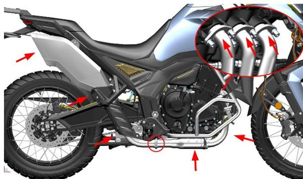
b. Si hay una ligera fuga de aire en la conexión Entre el motor y el silenciador, primero puede intentar apretar la tuerca de escape (3) con una llave hexagonal de 6#. Si el problema persiste, es necesario retirar el silenciador y reemplazarlo por una junta de escape nueva (4). El método de desmontaje específico se puede consultar en el apartado de desmontaje del silenciador.
