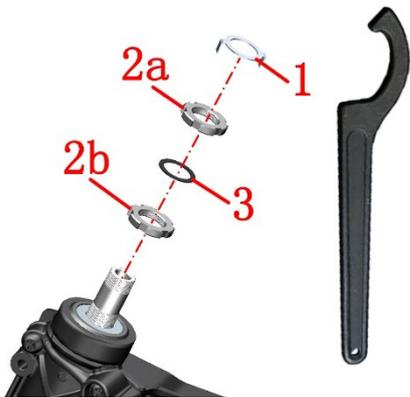
c. Si la dirección es pesada, afloje la tuerca de ajuste (2b)
