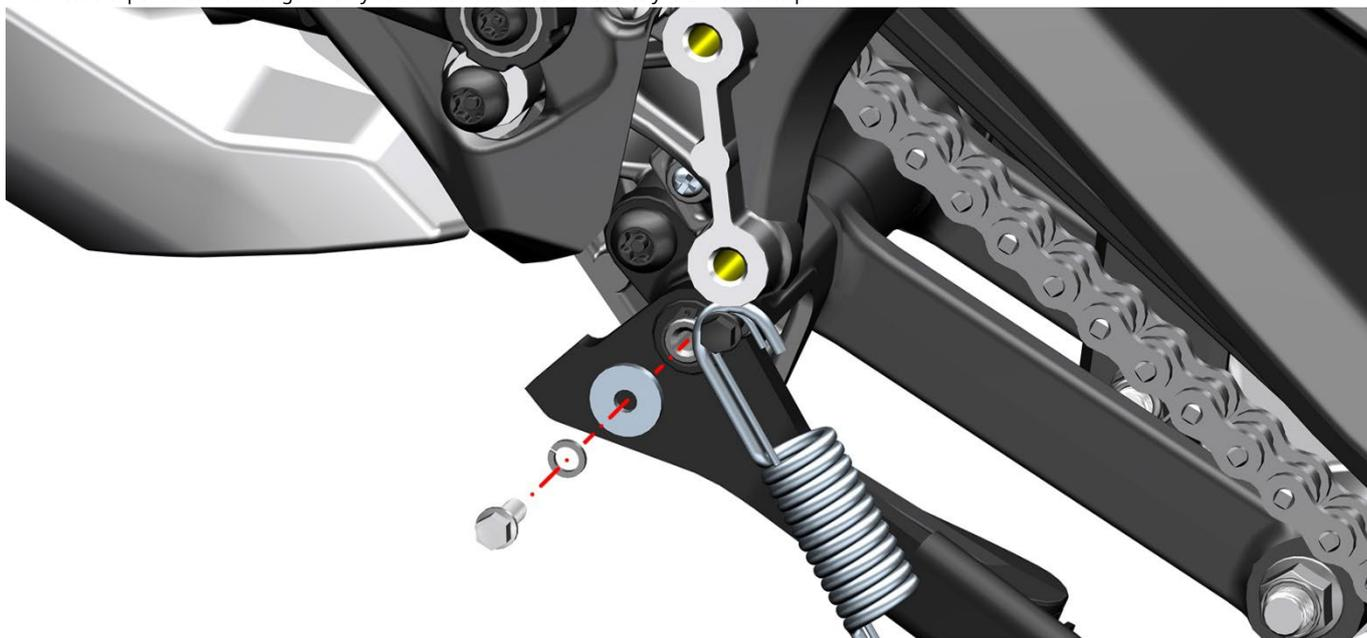
c. Consulte el método de extracción del resorte del soporte lateral para retirar el resorte del soporte principal. Después de retirar el perno del parte delantera del soporte principal (a) en sentido antihorario con un casquillo de flor de ciruelo T50 con orificios, gire el soporte principal hacia abajo hasta que el otro perno quede expuesto (b en la figura)
