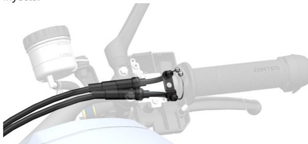
c. Si la falla de alta resistencia no se puede solucionar después lubricación, es necesario reemplazar el cable del acelerador.
