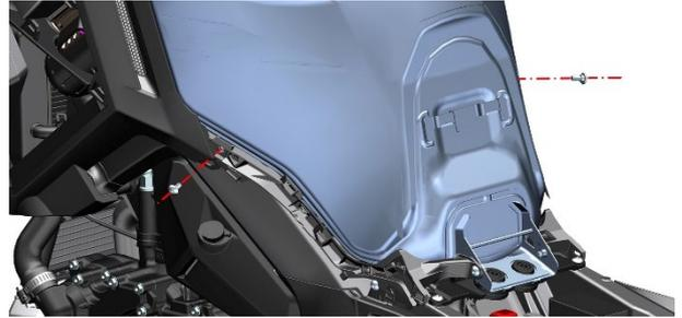
f. Utilice la herramienta hexagonal para quitar los 2 clavos de expansión. en la dirección que indica la flecha que apunta a la parte inferior del marco izquierdo y retire el lado derecho de la misma manera.
