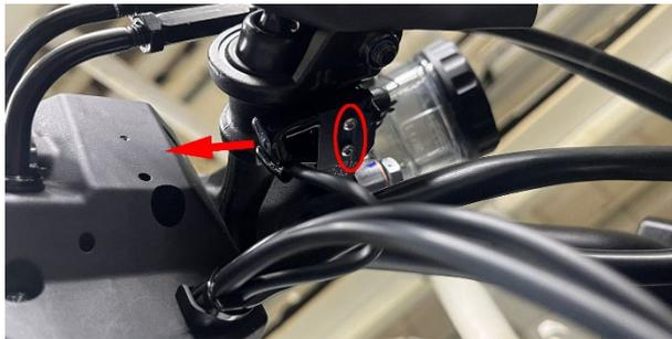
a. Extraiga los dos enchufes del interruptor del freno delantero en la dirección de la flecha, sin distinguir entre los polos positivo y negativo.
