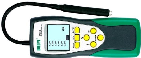
La imagen de arriba muestra el comprobador de humedad de líquido de frenos. La imagen proviene de internet y los derechos de autor pertenecen a su autor original. No la utilice para ningún otro fin.
