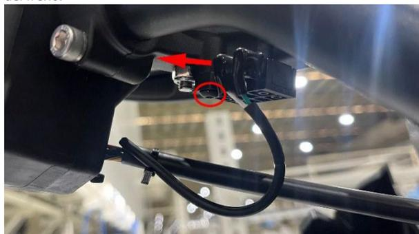
d. Retire el perno con un dado de 10 lb o una llave Torx para Reemplace la manija del embrague.
