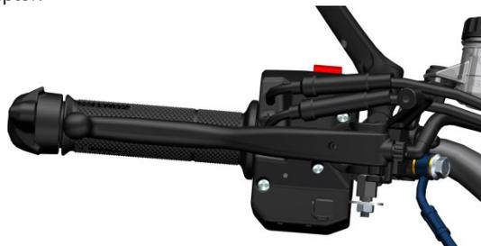
b. Use una jeringa para absorber el aceite de la máquina de coser y Inyecte una pequeña cantidad de aceite en el espacio entre la tapa del acelerador y el núcleo varias veces y gire el acelerador mientras inyecta.
