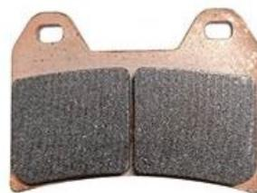
f. Compruebe el desgaste de las pastillas de freno de la pinza trasera desde la parte trasera. Si está cerca de desgastarse la placa base, es necesario reemplazar las pastillas de freno por otras nuevas de dos en dos.
