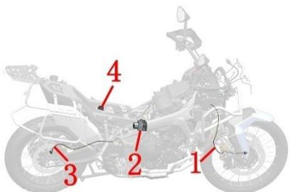
1-Sensor de velocidad de la rueda delantera 2-Unidad de control hidráulico del ABS 3-Interfaz de diagnóstico 4-OBDD del sensor de velocidad de la rueda trasera
