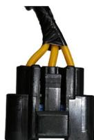
d. Compruebe si el conector 3P de color amarillo del cable está El lado del estator del magneto no tiene conductividad a tierra. Si la resistencia o la conductividad a tierra son incorrectas, es necesario reemplazar el estator del magneto.
