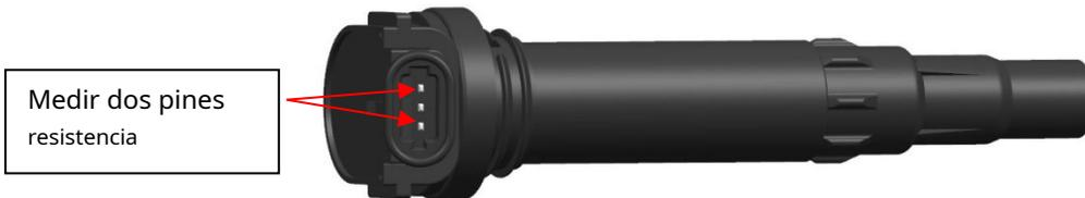
Si desea reemplazar la bobina de encendido, puede seguir los pasos a continuación:
