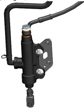
c. Utilice un destornillador Phillips para quitar la expansión. clavijas que sujetan la taza de aceite del freno trasero en su lugar.
