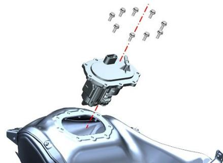
Al volver a montar, es necesario apretar previamente en diagonal y luego apretar 9 pernos, de lo contrario, la compresión desigual del anillo de goma de sellado de la bomba de combustible provocará fácilmente fugas y posibles riesgos de seguridad.
