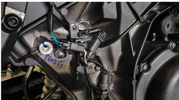
b. El método de eliminación de RMC-HU se detalla en la sección Al retirar la pinza del freno de disco trasero delantero. Retire directamente el tubo RMC-HU. Extraiga el tubo RC-HU y el sensor de velocidad de la rueda de la abrazadera de tres piezas.
