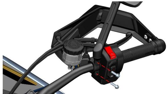
c. Incline el cilindro principal del freno delantero de manera que los pernos queden Mirando hacia arriba, use guantes impermeables, retire los pernos con una manga de 12 lb, retire la almohadilla de cobre y el tubo de aceite FMC-HU, y vacíe el líquido de frenos en el cilindro principal. Par de apriete estándar de los pernos: 32 N.m (3,3 kgf.m, 24 lbf.ft).
