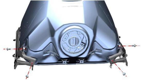
d. Empuje la placa de revestimiento de malla de la cubierta izquierda y derecha conjunto en la dirección de la flecha y retire el conjunto después de empujarlo hasta la posición del orificio.
