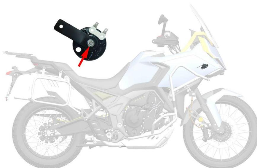
Si necesita quitar la bocina, si el parachoques está instalado, inserte una llave T25 en el soporte de montaje delantero del parachoques, sobre el guardabarros delantero, para quitar los pernos. Extraiga la bocina y desenchúfela para retirarla.
