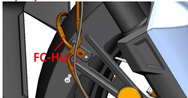
e. Desate los dos tubos de aceite en el interior del marco izquierdo. y saca los dos tubos de aceite de la parte delantera.
