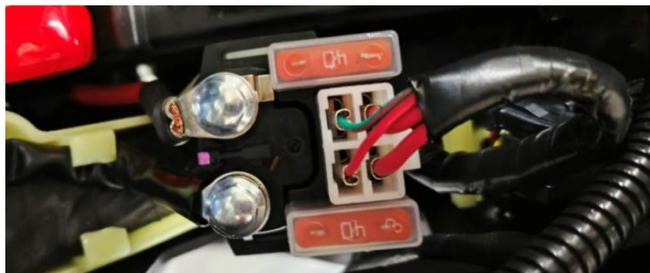
Al reinstalar el relé, el cable rojo se conecta al orificio roscado del relé marcado con una "B" y el cable negro al orificio roscado marcado con una "M". Asegúrese de que la tapa protectora esté cerrada después de apretar los tornillos y luego conecte el conector del relé.
